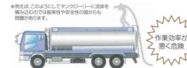
こんな時、地上あるいは天井よりあらかじめ、車の積込口まで配管により注入口をもってきておき(下図のように)簡単な操作で迅速に作業ができるよう設計されたものがローディングアームです。
