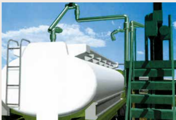
立ち上がり型、およびつり下げ型があります。 Upright and Overhead Suspension Type Loading Arms are available.
